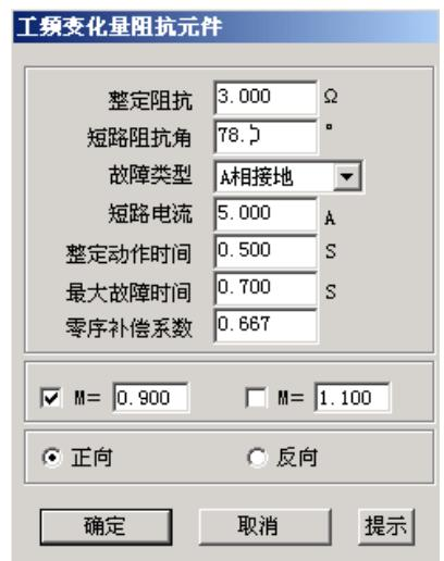
M 的值默认情况下有 0.9 和 1.1 两种设置，一般地，M=0.9 时，保护应可靠不动作，M=1.1 时，保护应可靠动作。设置 M=1.2 时，可以测出保护的动作时间。点击界面中“提示”按钮可以获得更多提示。
