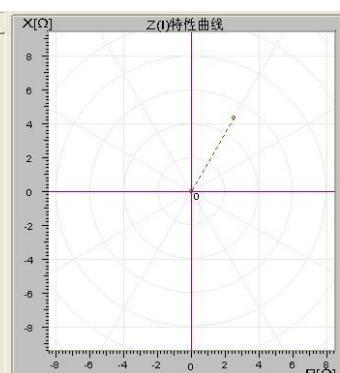
本试验的方法过程很像做差动继电器试验。如果把这里的阻抗比做差动试验的“制动电流”，则这里的电流就相当于“动作电流”。试验时，阻抗初始值为0，按一定的搜索步长增加。测试在每一个阻抗值下，保护的动作电流。测试完毕，软件会自动绘制出相应的曲线。“Z(V)特性曲线”参照“Z(I)特性曲线”。
