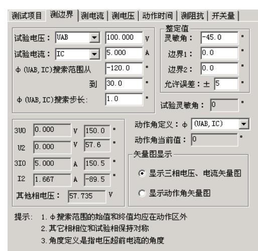
般取线电压和第三相的相电流，如取电压  $U_{AB}$ ，电流  $I_C$ 。有时也可以选一相电压和一相电流进行试验，但一般不选线电流。注意，所选电压电流的值可以设定，但未被选择的各相电压值均等于额定电压，角度保持对称，未被选择的各相电流均为 0。
