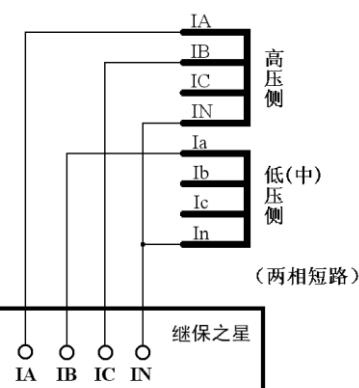
在“交流试验”中，当在 I 侧 A 相加入  $1*1.920A=1.920A$  (1 为标么值) 单相电流，在 I II 侧 A 相加入  $1*1.732*6.925A=11.994A$  单相电流时，装置应无差流。
