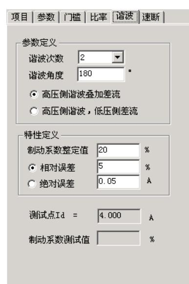
当谐波分量较大时（大于谐波制动系数比例），谐波将制动住差动动作电流使保护不会出口。因此，谐波制动系数测试方法是，固定某一基波差流值  $I_d$ ，变化谐波电流值  $I_{xb}$ ，通过双向搜索的方式查找出谐波电流能制动住的临界点的比值，即谐波制动系数  $K_{xb}$ 。
