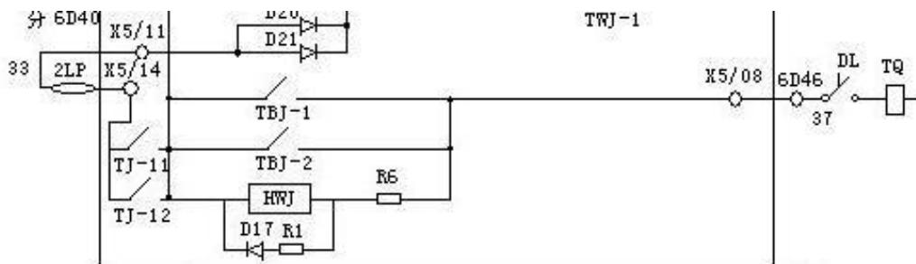
对照上图, 我们在回到上面“接线误区”中提到的内容。刚才提到的 TQ, 就相当于上图中的 TQ; 刚才提到的 1DL, 就相当于上图中的 DL; 刚才提到的 37 端子, 就相当于上图中的 X5/08 接点。所以是不正确的。
