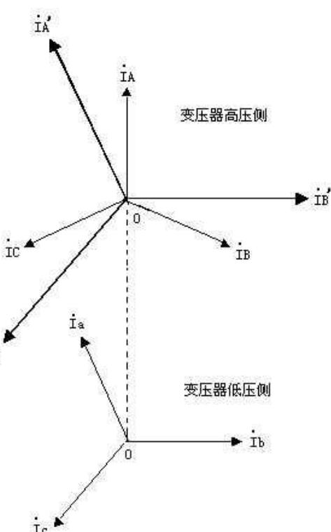
所以高压侧C相上有了电流，并且与A相上的电流大小相等，方向相反。试验时，为了平衡高压侧C相上的电流，就在低压侧的c相上加一补偿电流，并且，所加的补偿电流应与加在低压侧a相上的电流大小相等，方向相反。
