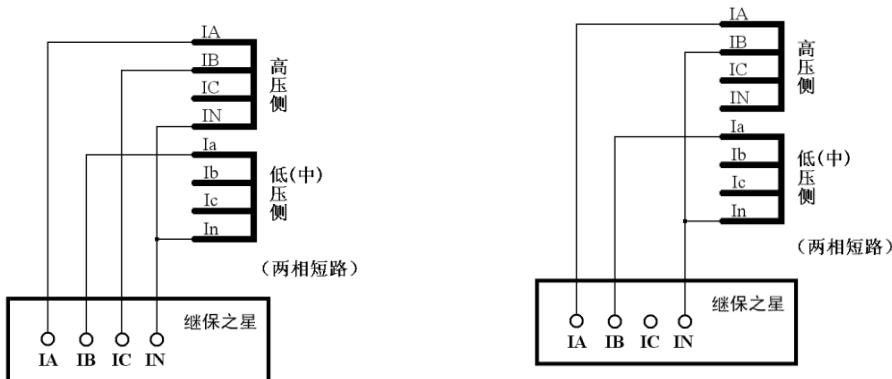
测试仪输出三路电流,  $IC$  为补偿电流
