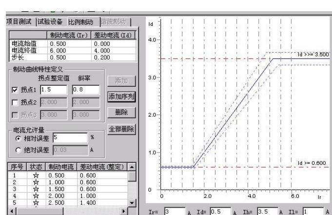
起作用。差动电流步长的设置根据保护的要求精度来设置，如果要求精度高我们就把步长设置小些。
